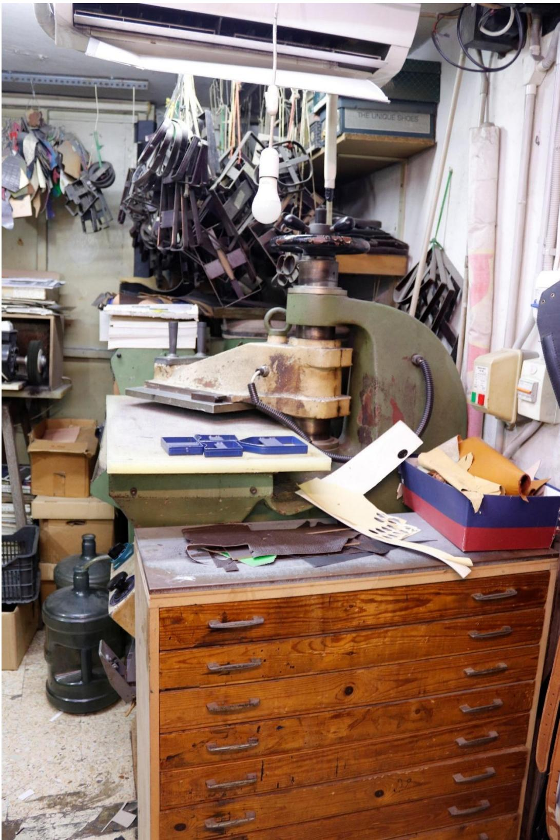
صورة 71. مكبس قص هيدروليكي بذراع متراجع مع قوالب قص معلقة في ورشة صناعات جلدية (من ورشة روبيرت توکادجیان) يستخدم لقص القطع الجلدية باستخدام قوالب معدنية. يظهر لوح القص الأبيض من البولي إيثيلين فوق الطاولة حيث توضع الجلد ويُطبع القالب عليها بقوة الكبس. على الجدار الخلفي قوالب قص معلقة بأشكال مختلفة، أما الأدراج الخشبية السفلية فمخصصة غالباً لحفظ القوالب والبلاطونات. على السطح قطع جلد ومخلفات قص جاهزة للفرز.
